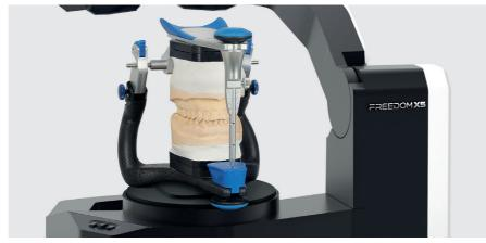
500万画素のカメラが模型の色をマウントされた状態をスキャンし、咬合関係(高径)をそのまま再現します。 綺麗に再現するため、マージンライン 臨床で一般的に使用する咬合器なども使用することができるため、作業時間を
